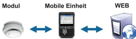
Diese Variante funktioniert wie Variante A mit dem Zusatz, dass durch Einsatz der CAPTEC MobileSoftware der Datenaustausch durch diese Software ermöglicht wird. Diese Software erlaubt es auch im Offline-Betrieb (Netzverbindung NICHT notwendig) zu arbeiten. (kein DAVIS möglich)
